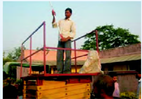
चित्र सं.-3 हाइड्रॉलिक टाली पर चढ़कर फल तुड़ाई यंत्र का प्रयोग
